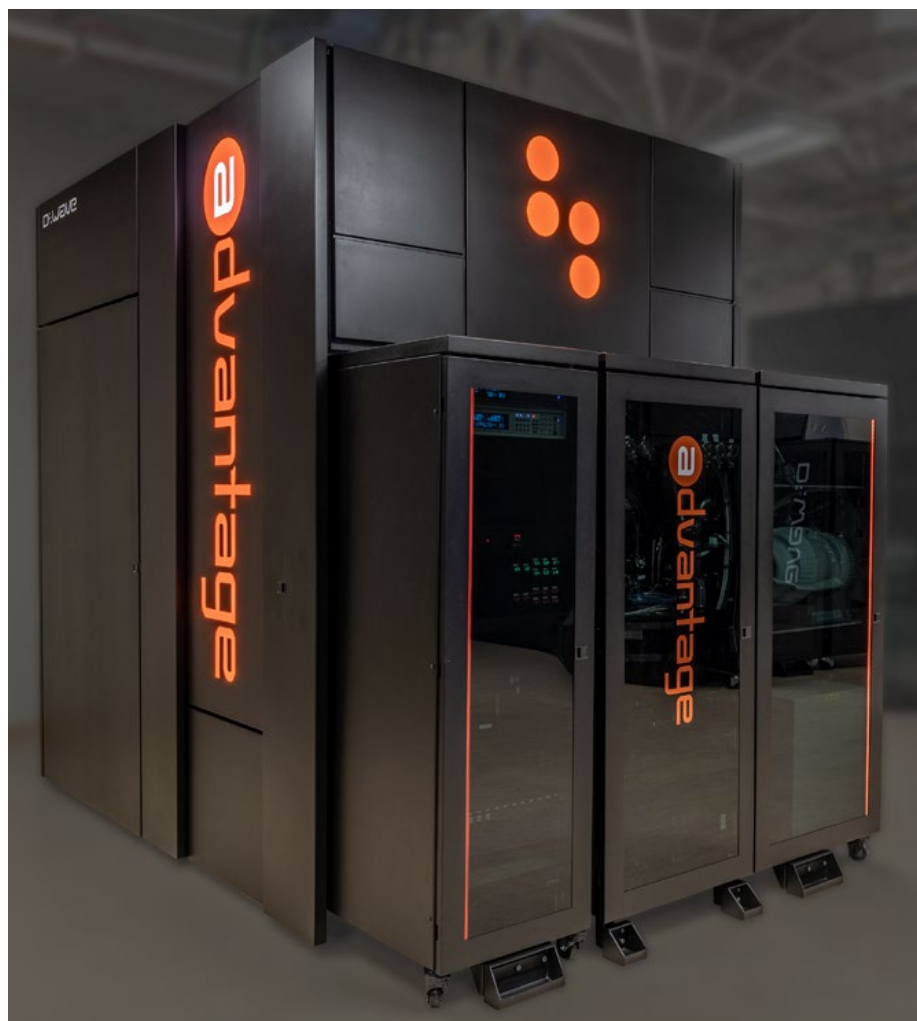
Die kanadische Firma D-Wave bietet schon seit Jahren kommerzielle Quanten-Annealer an. Im Bild ein Advantage-System, ein analoger, nicht universeller Quantencomputer mit über 5000 Qubits. Ein solcher steht im deutschen Forschungszentrum Jülich. Foto: D-Wave
