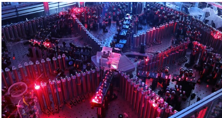
Der optische Quantencomputer-Prototyp «Jiuzhang» der University of Science and Technology of China ist aufgabenspezifisch gebaut und daher nicht programmierbar. Foto: USTC
