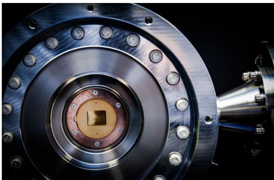
Ein Quantenchip nach dem Prinzip der Ionen-Falle. Beim Betrieb ist er in der hier offenen Kammer abgeschirmt. In der Mitte des Chips verläuft eine Rinne; sie nimmt die einzelnen Ionen auf, die als Qubits dienen. Sie sind in einer Linie aufgereiht. Foto: Quantinuum
