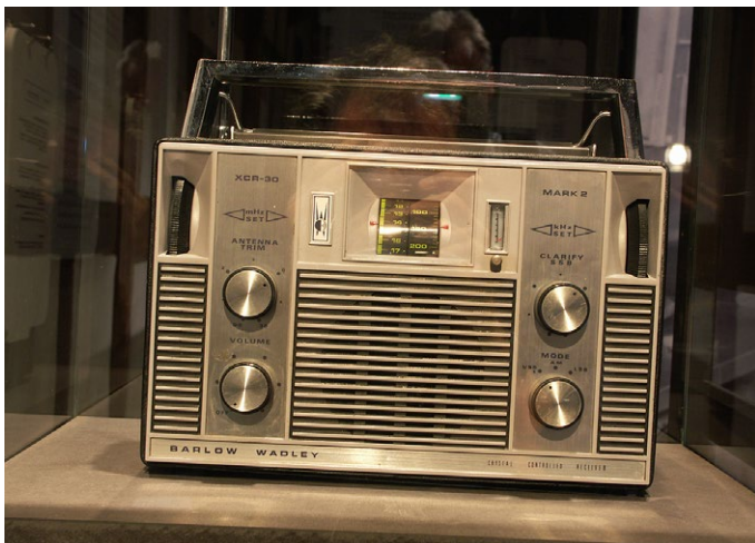
Rundfunkempfänger des Systems Phönix, Model Barlow Wadley XCR 30 Mark 2. Herstellung in Süd-Afrika von Ende 1971 bis 1982 durch die Barlow Television Company. Frequenzbereich: 0,5 bis 30 MHz. Dieses Empfängermodell war damals eines der besten der Welt. Gerät: Sammlung ZSHAM; Foto: Roland Kallmann
