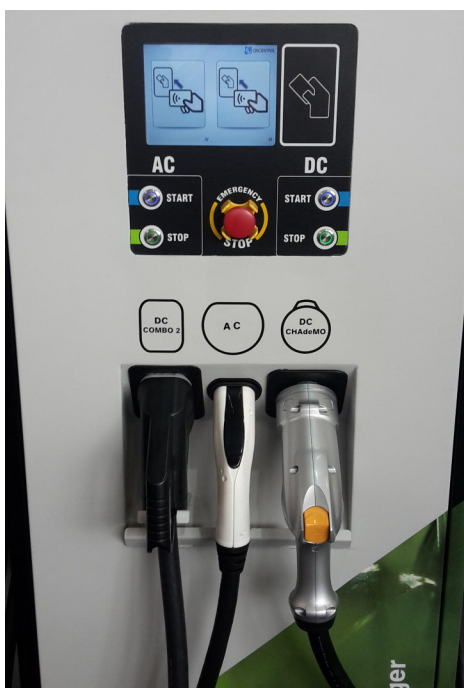
Ladesäule mit Typ-2-, Combo-2- und CCHdeMO-Anschluss. (Quelle: Wikipedia, User Hadhuey)
