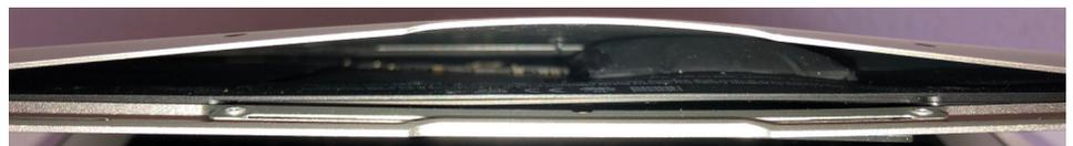
Beim Lösen der beiden Schrauben vorne in der Mitte wurde der Bodendeckel richtig hochgedrückt.
