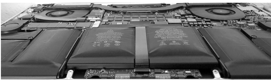
Aufgeblähte Batterie Elemente im MacBook Pro 15" (Retina, Mitte 2015). Bild: Werner Widmer
