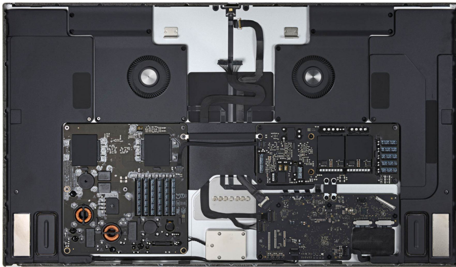
Inneres mit zwei massiven Lüftern.
