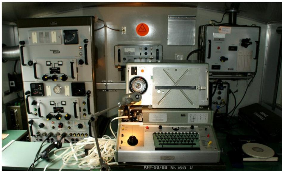
Funkstation SE-415 mit Kryptofunkfernreiber KFF 58 und Verschlüsselungsgerät. (Bild: armyradio.ch)
