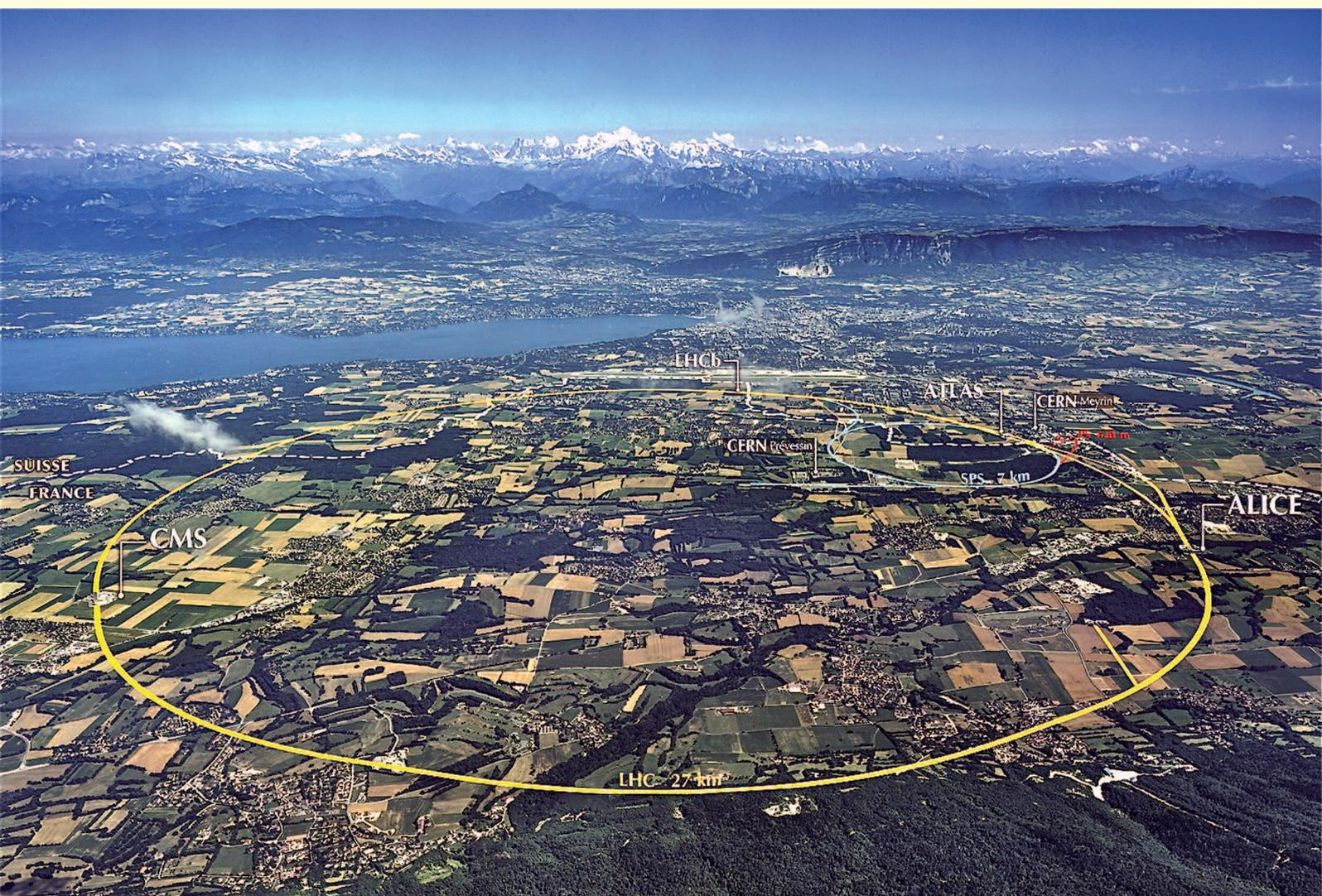
Im 26,7 Kilometer langen unterirdischen Ringtunnel – dem Large Hadron Collider (LHC) – werden Protonen gegenläufig auf nahezu Lichtgeschwindigkeit beschleunigt und zur Kollision gebracht. Foto: CERN
