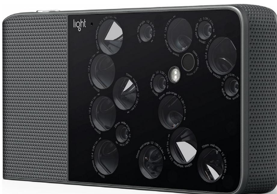
Die Light L16 Kamera nutzt gleichzeitig 16 Objektive und errechnet daraus 52 Megapixel.
