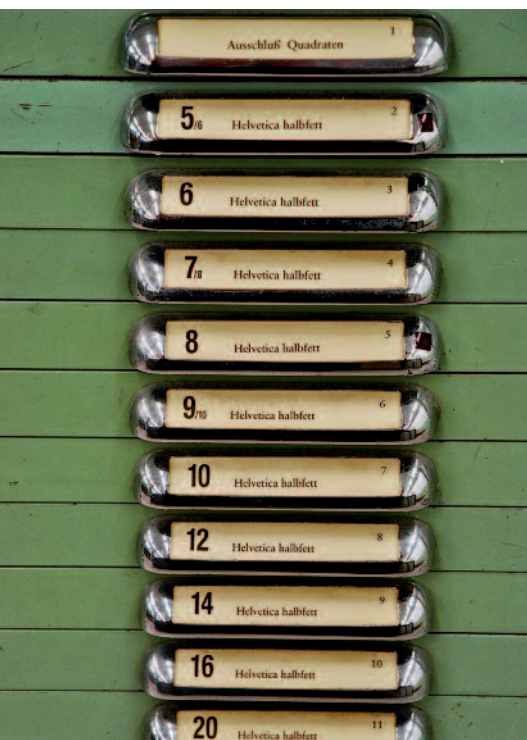
Der «Schriftenordner Helvetica» im Bleisatz. Für jede Grösse, jeden Schnitt (kursiv, fett) gab es einen Setzkasten.
