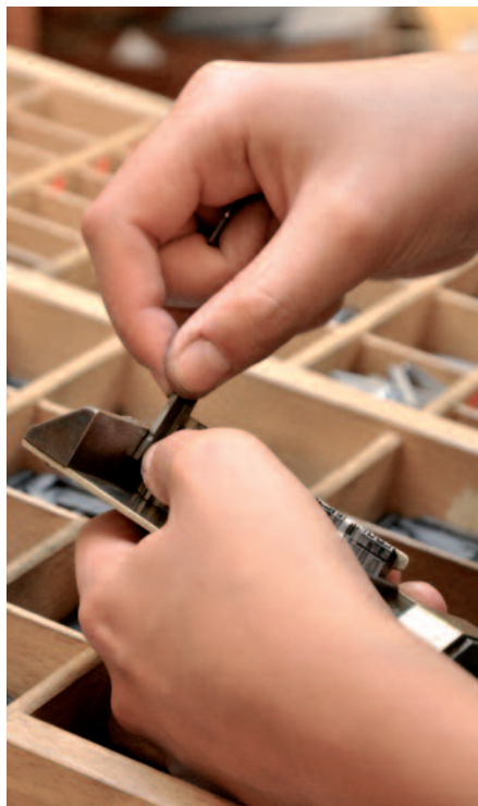
Handsatz aus dem Setzkasten: Im Winkelhaken werden die einzelnen Buchstaben und Zeilen aneinandergereiht.
